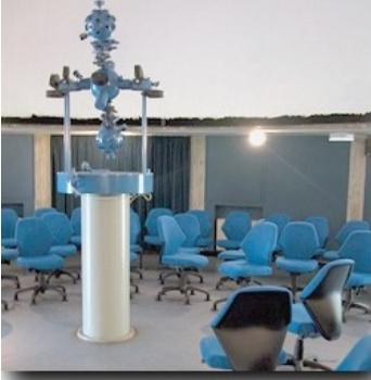
Il Planetario è un proiettore in grado di riprodurre su una cupola l'immagine della volta stellata visibile ad occhio nudo da ogni parte del mondo. Lo strumento, grazie ai suoi meccanismi permette di riprodurre i principali moti celesti. Le stelle che si contano sulla cupola sono alcune migliaia e di fronte a questa insolita distesa di astri lo spettatore potrebbe
