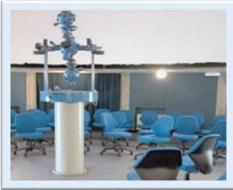
Il Planetario è un proiettore in grado di riprodurre su una cupola l'immagine della volta stellata visibile ad occhio nudo da ogni parte del mondo. Lo strumento, grazie ai suoi complicati sistemi meccanici, permette di riprodurre i principali moti celesti. Le stelle che si contano sulla cupola sono alcune migliaia e di fronte a questa insolita distesa di astri lo spettatore
