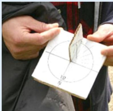
Nell'attività di laboratorio pratico viene fatto costruire ad ogni alunno un semplice strumento in grado di determinare la direzione del Nord conoscendo l'ora del giorno (bussola solare). Lo strumento può anche essere usato, al contrario, come orologio solare conoscendo la direzione del Nord. Lo strumento viene realizzato con materiali semplici e di recupero (carta, cartone, chiodi). Al termine del laboratorio ogni alunno potrà portare con sé l'oggetto costruito e utilizzarlo a scuola e a casa.
