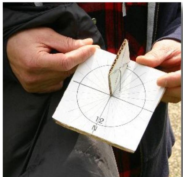
strumento in grado di determinare la direzione del Nord conoscendo l'ora del giorno. Lo strumento può anche essere usato, al contrario, come orologio solare conoscendo la direzione del Nord. Lo strumento viene realizzato con materiali semplici e di recupero (carta, cartone, chiodi).
